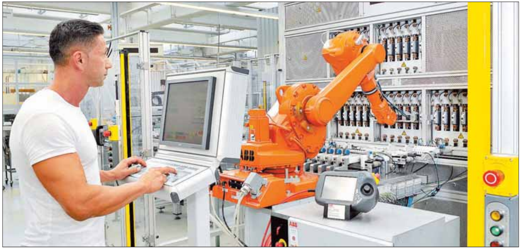
Alle bei der ABB Stotz-Kontakt GmbH in Heidelberg-Pfaffengrund hergestellten Sicherungsautomaten müssen eine thermische Überlastprüfung bestehen. Fotos: Alfred Gerold
