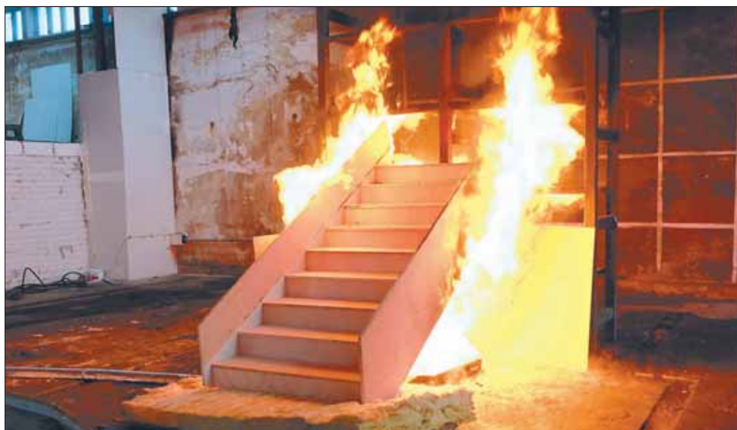
Selbst ein Feuer mit 900 Grad Hitze kann Uwe Stadters Brandschutzfolie nichts anhaben. Beim Test hielt eine an der Unterseite mit der Folie beklebte Holztreppe dem Brand stand, während eine ungeschützte Treppe schon nach wenigen Minuten zusammenbrach. Foto: privat
